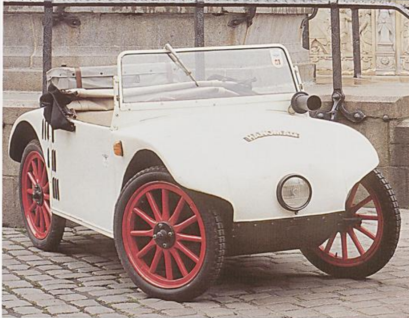
Erster deutscher Kleinwagen: Hanomag „Kommissbrot“, Baujahr 1925, Einzyylinder-Viertaktmotor, 500 ccm, 10 PS, 60 km/h, Historisches Museum Hannover
