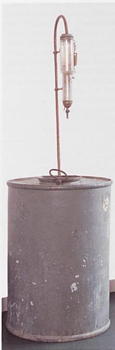
Petroleumfass mit Handpumpe und gläsernem Messzylinder, Deutsches Erdölmuseum Wietze. Solche Fässer mit Pumpe wurden auch zum Benzinverkauf eingesetzt
