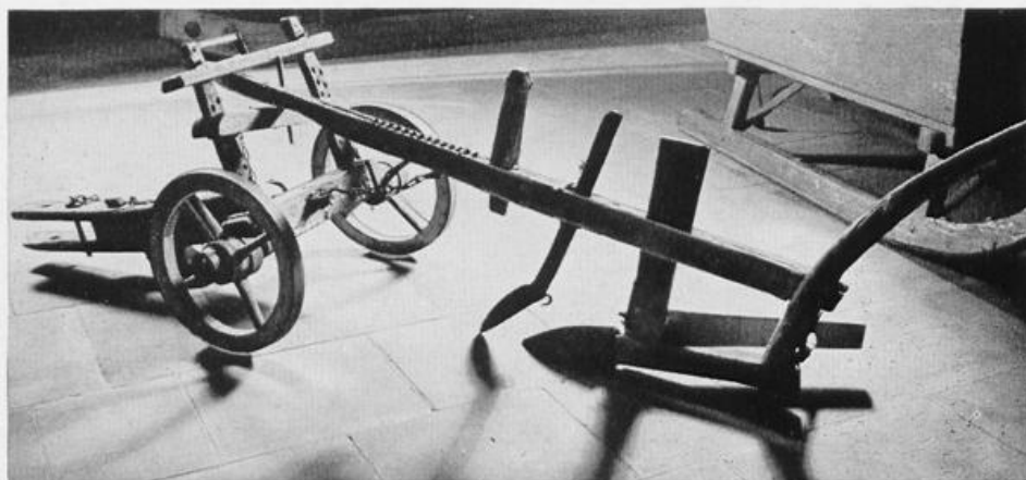
„Ümmewender“ aus Plettenberg. Der Pflug hat anstatt einer Pflugschar eine Eisenspitze.
