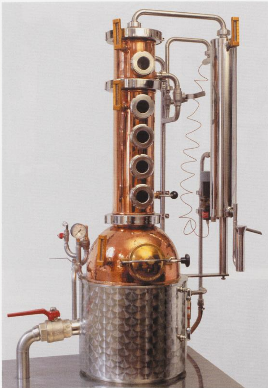
Destillierapparat zur fraktionierten Destillation. Hiermit wurde im Jahre 2003 der Jubiläums-Himbeergeist destilliert.
