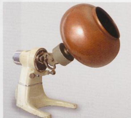
Korsch-Tabletten-Maschine (Tagesleistung ca. 40.000).
