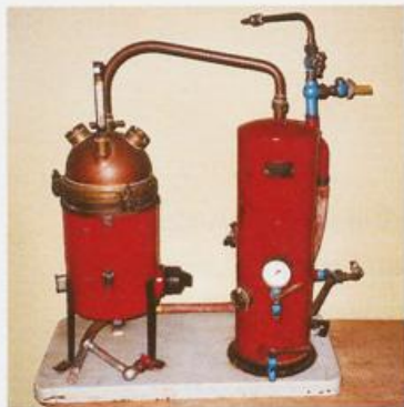
Vakuum-Destillier-Apparat der in den dreißiger Jahren angeschafft wurde.
