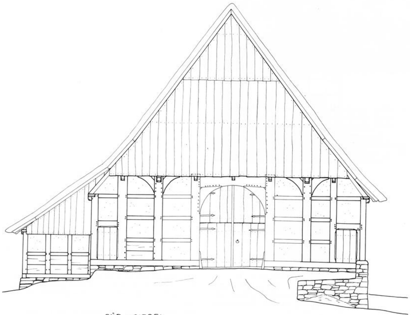
SÜD - GIEBEL - REKONSTRUKTION - (MIT STALLANBAU VON 1855)
